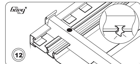
Установить резаную панель с надетым на нее торцевым профилем. Для дополнительной фиксации резаной панели в торцевом профиле можно использовать фрагменты отрезанных частей или скжатый межпанельный профиль.
