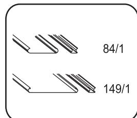
Несущий профиль (стрингер) традиционно производится из оцинкованной стали.
