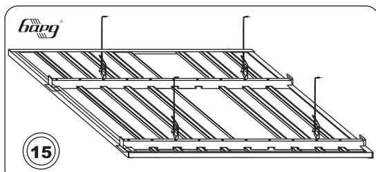
Установка оставшихся панелей. Все панели монтируются также как показано выше, кроме последней (или последних двух панелей). Межпанельные профили устанавливаются по мере монтажа панелей
