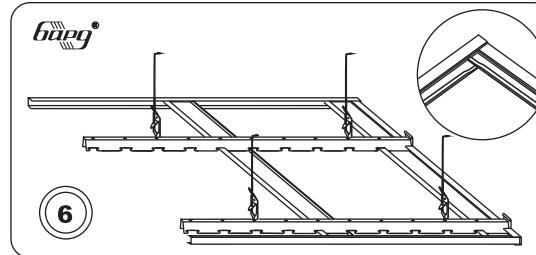
Установить два торцевых профиля, перпендикулярных первой панели. Установить еще одну или несколько панелей равномерно по всей длине стрингеров.
