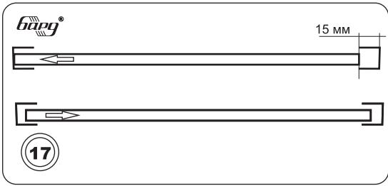
2-й способ: при меньшей длине панели, она укорачивается на глубину торцевого профиля (15 мм). Далее один край панели до упора заводится в торцевой профиль и обратным движением установить панель и защелкнуть на посадочном месте.
