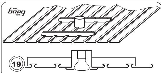
Светильник может устанавливаться в две панели. Полуокружности в каждой из двух панелей вырезаются таким же способом.
