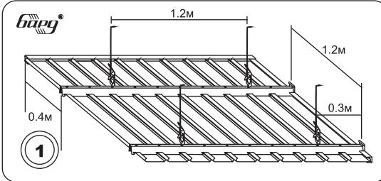
Максимальные размеры для разметки потолка. Стрингеры должны быть установлены строго параллельно друг к другу
