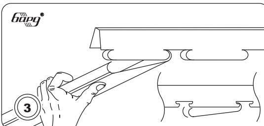
Установка первой панели. Панель с незначительным усилием (нажатие на край панели) защелкнуть на стрингере. Панель предварительно укоротить на 3-5 мм от реального размера помещения.
