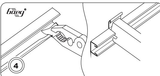
Углы нижней полки торцевого профиля поджать пассатижами через мягкую прокладку 1.5 см. Верхнюю полку в местах сопряжения со стрингерами подрезать и отогнуть наверх
