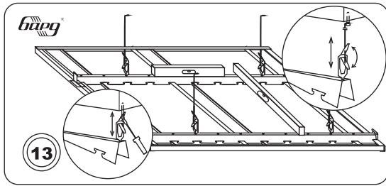
Регулировка высоты производится передвижением регулировочных пружин по спицам или с помощью саморезов (глубиной ввинчивания саморезов). Контроль производится водяным уровнем. На этом этапе важно сразу сделать разметку на панелях под светильники, чтобы не забыть об этом во время набора панелей.
