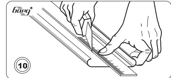
Разрезать панель вдоль по проведенной линии, несколько раз сильно провести ножом по месту реза
