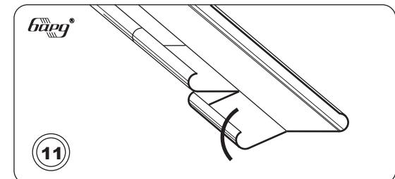
Чтобы избежать коробления панели, ту часть ее, которая будет отрезана, разрезать ножницами на куски 30 см, и поочередно отгибая куски в разные стороны (вверх-вниз), отламывать их.
