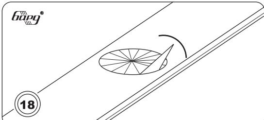
Врезка светильников R50. На панели (или на двух) вырезается окружность ножом по шаблону. После очерчивания окружности ножницами от центра к краям вырезаются сектора. Далее, чтобы избежать коробления панели, каждый из секторов отгибается и отламывается. Чем больше секторов, тем ровнее получится вырезанный круг.
