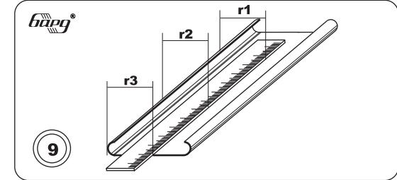
На очередной панели отложить эти расстояния и разметить панель для резки.
