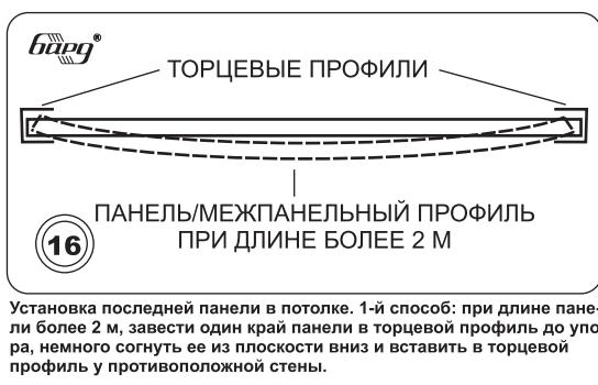
Установка последней панели в потолке. 1-й способ: при длине панели более 2 м, завести один край панели в торцевой профиль до упора, немного согнуть ее из плоскости вниз и вставить в торцевой профиль у противоположной стены.
