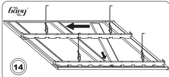
Установка оставшихся панелей. Каждую панель подрезать на 3-5 мм меньше реального размера помещения в данном месте. Вводить панель в два торцевых профиля, расположив ее по диагонали к торцевым, параллельным стрингерам. Выпрямить панель и аккуратным нажатием застегнуть ее на посадочном месте.
